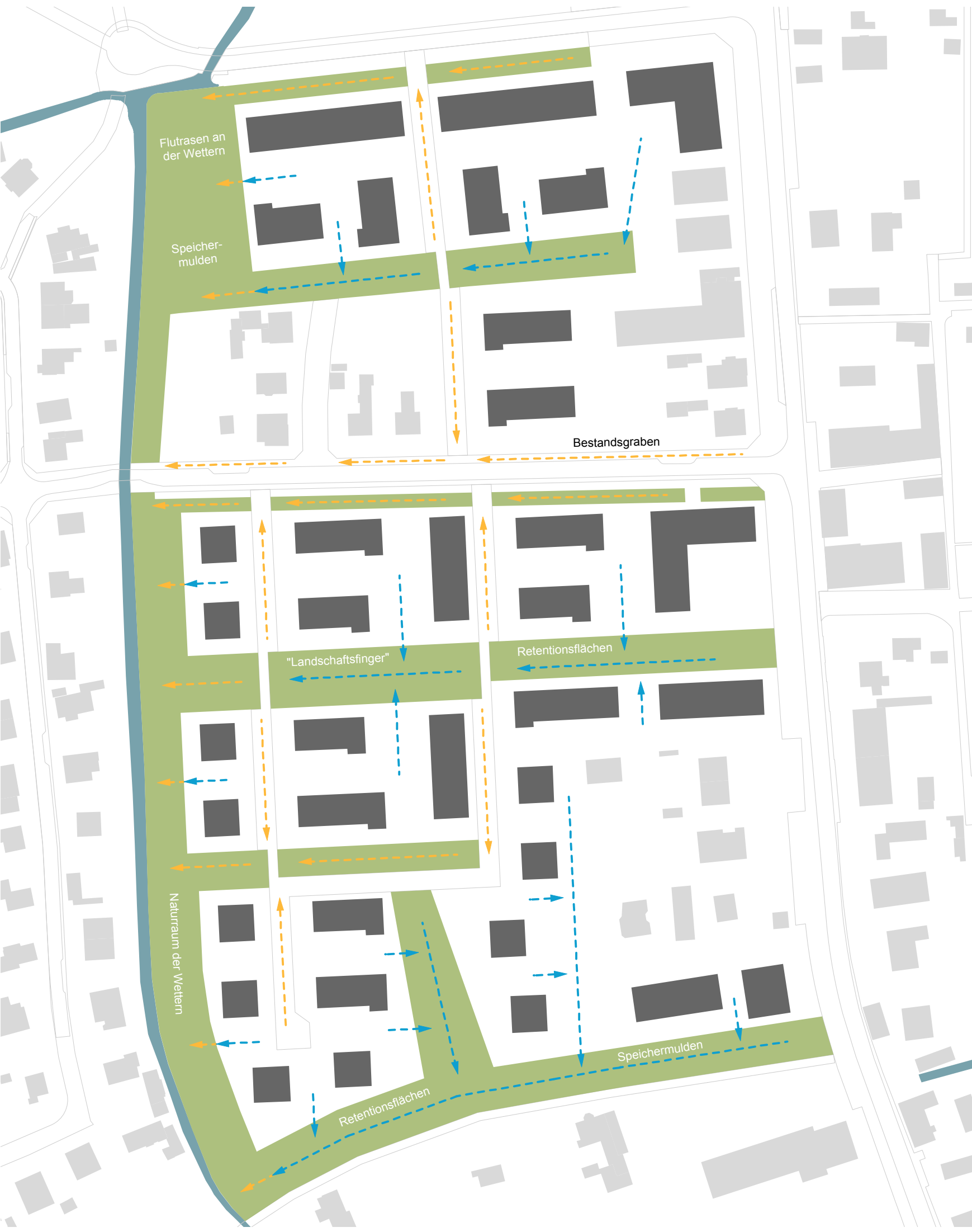
KONZEPT ENTWÄSSERUNG Private Entwässerung Öffentliche Entwässerung
